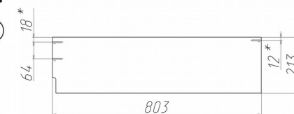
Рис.5 Разметка отверстий на перегородке (11)
